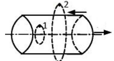
**Решение.** Магнитное поле коаксиального кабеля обладает цилиндрической симметрией, т. е. магнитные силовые линии имеют форму окружностей, центры которых лежат на оси кабеля, а плоскости перпендикулярны оси. Это значит, что во всех точках магнитной силовой линии модуль вектора  $\mathbf{B}$  одинаков. Применим теорему о циркуляции вектора  $\mathbf{B}$ :
