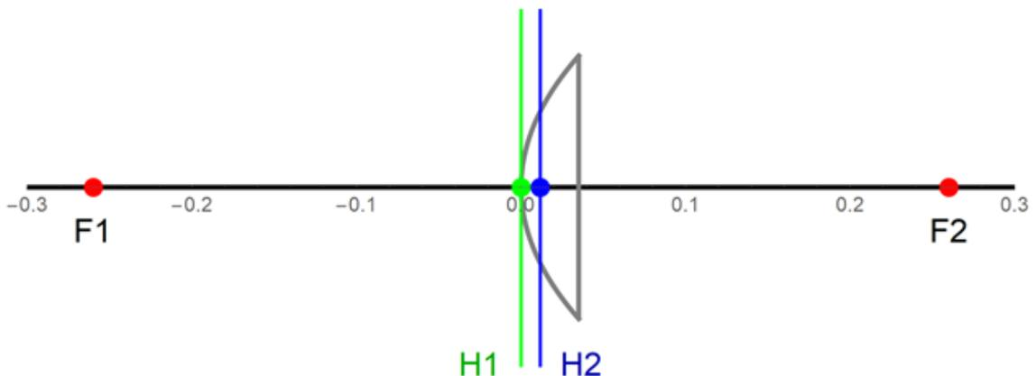
3.2. Найти положение главных и фокальных плоскостей для двояковыпуклой линзы  $n = 1.5$  (в воздухе) толщиной 3.5 см, у которой радиусы кривизны сферических поверхностей равны 13 см. Привести элементы матрицы преломления и схематический чертеж.
