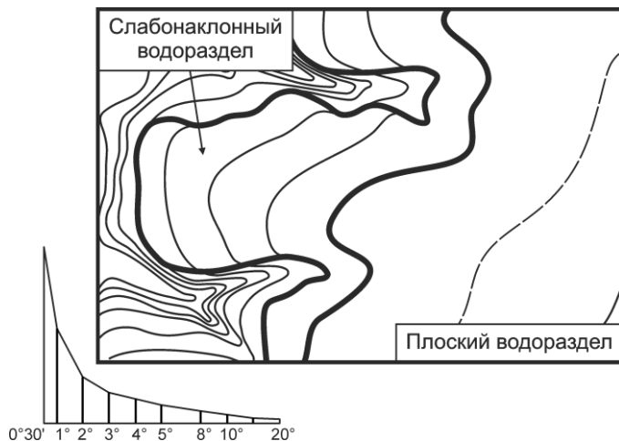
Рис. 9. Плоский и слабонаклонный водоразделы
