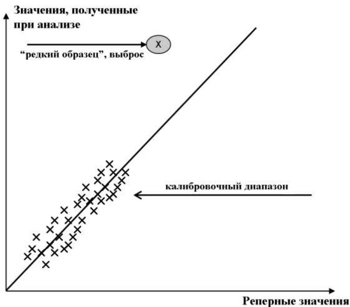
Рис.5.1 Выбор диапазона концентраций: Образцы с концентрацией «типичного» диапазона хорошо лежат на корреляционной зависимости. Аналит с не типичной концентрацией определяется как выброс.
