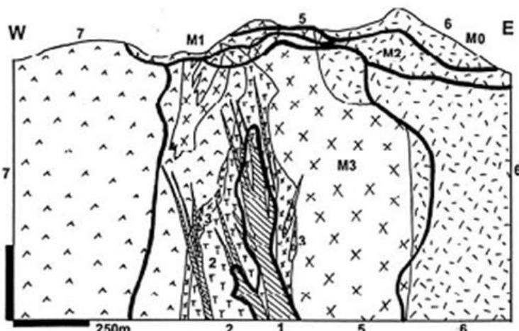
**Пример ответа:** Бату Хиджау является классическим медно-порфировым месторождением с золотым оруднением. На геологическом разрезе оруднение локализуется в зоне M1 и M3. Оруднение пространственно и генетически связано с тоналитовыми порфиритами и кварцевыми диоритами.
