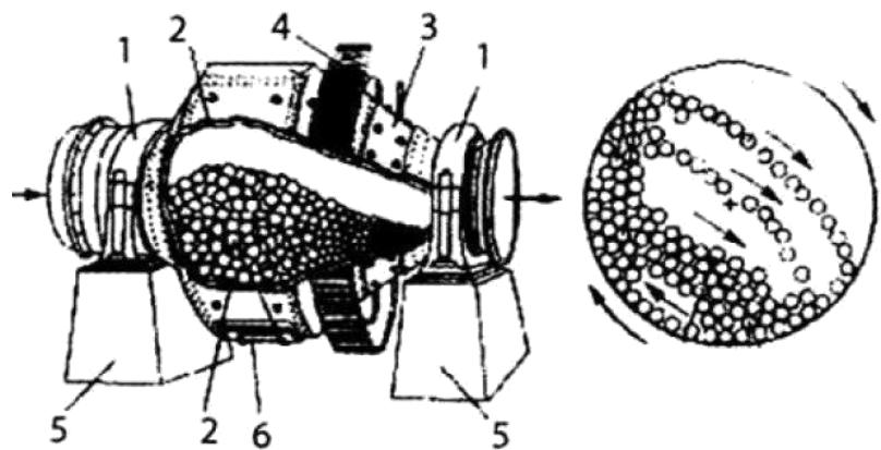
**Ответ: цилиндрическая шаровая мельница**
