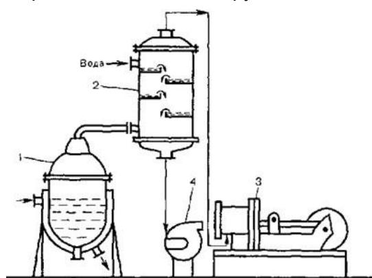
**Ответ: вакуум-выпарная установка с прямоточным конденсатором смешения**
