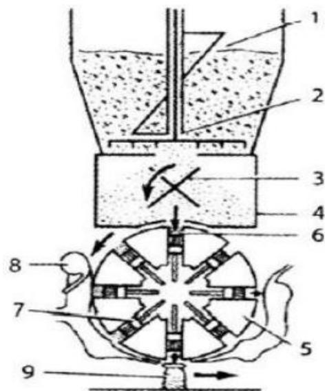
**Ответ: камерный вакуумный дозатор порошков**
