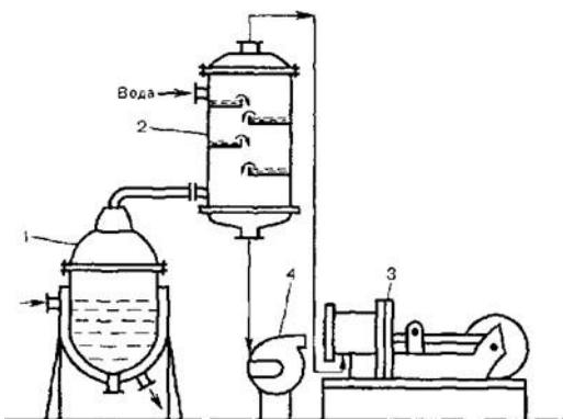
**Ответ:** Вакуум-выпарной установки с противоточным конденсатором смешения
