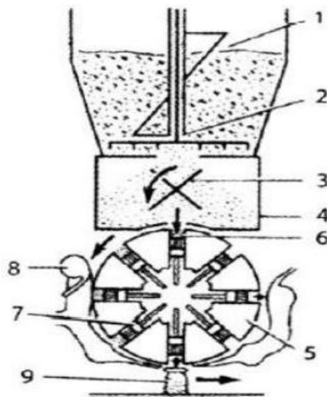
Ответ: камерный вакуумный дозатор порошков
