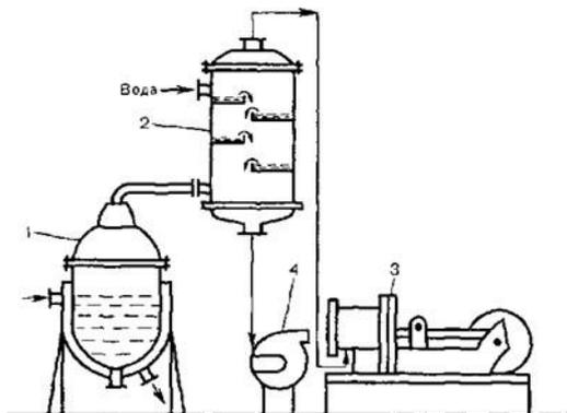
**Ответ:** Вакуум-выпарной установки с противоточным конденсатором смешения
