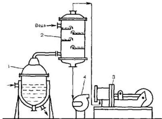
**Ответ: вакуум-выпарная установка с прямоточным конденсатором смешения**
