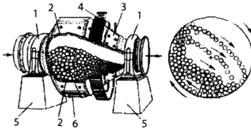
Ответ: цилиндрическая шаровая мельница
