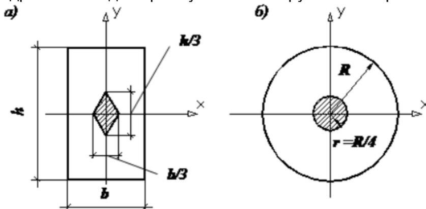
Для прямоугольника ядро сечения имеет форму ромба (а), а для круглого сплошного стержня ядро сечения – круг (б).
